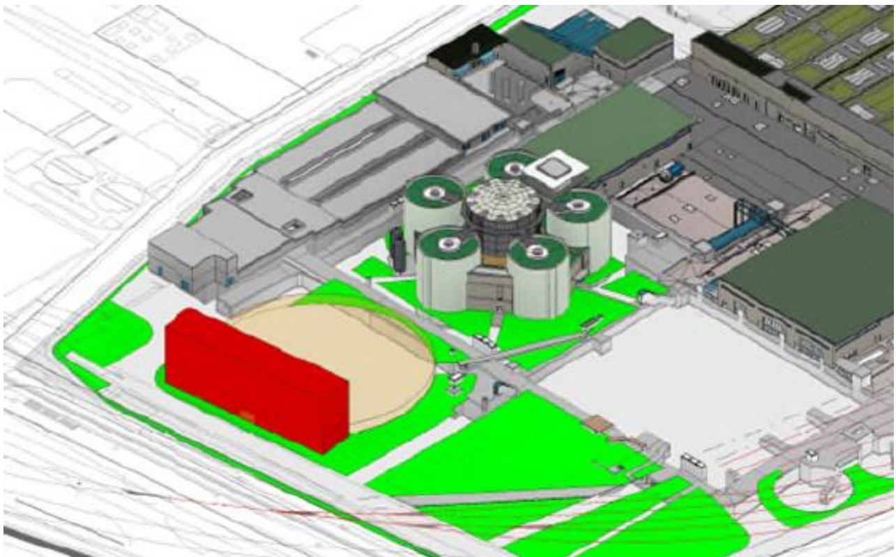
Abb. 4: Verschiebung des Betriebsgebäudes der ProRhero (rot) mit Abbruch des bestehenden Nachklärbeckens (beige)
